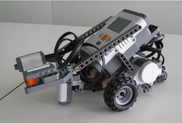
Fig. 2. Robot Bender. Se observa ruedas, motores y sensores
