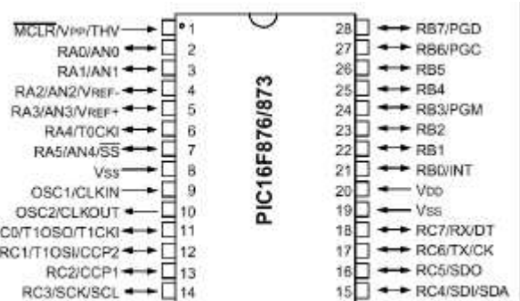
Figura 5.- Encapsulado y patillaje del PIC16F876
