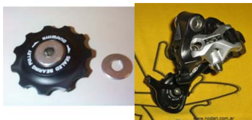
Aquí se observan una roldana y el cambio de donde se puede extraer
