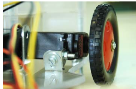
Fig 4. Detalle de fijación motor-rueda-estructura.
